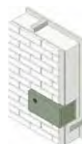
Huismuskasten in de gevel
